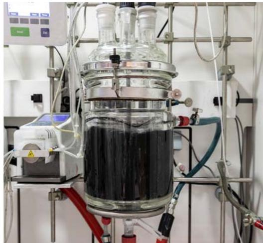
Gemeinsam mit Sibanye-Stillwater haben wir einen Katalysator auf Rutheniumbasis entwickelt, um potenzielle Versorgungsengpässe bei Iridium zu vermeiden. Mit dem neuen Katalysator werden nur 30–150 Kilogramm Iridium benötigt, um ein GW Kapazität aufzubauen.
