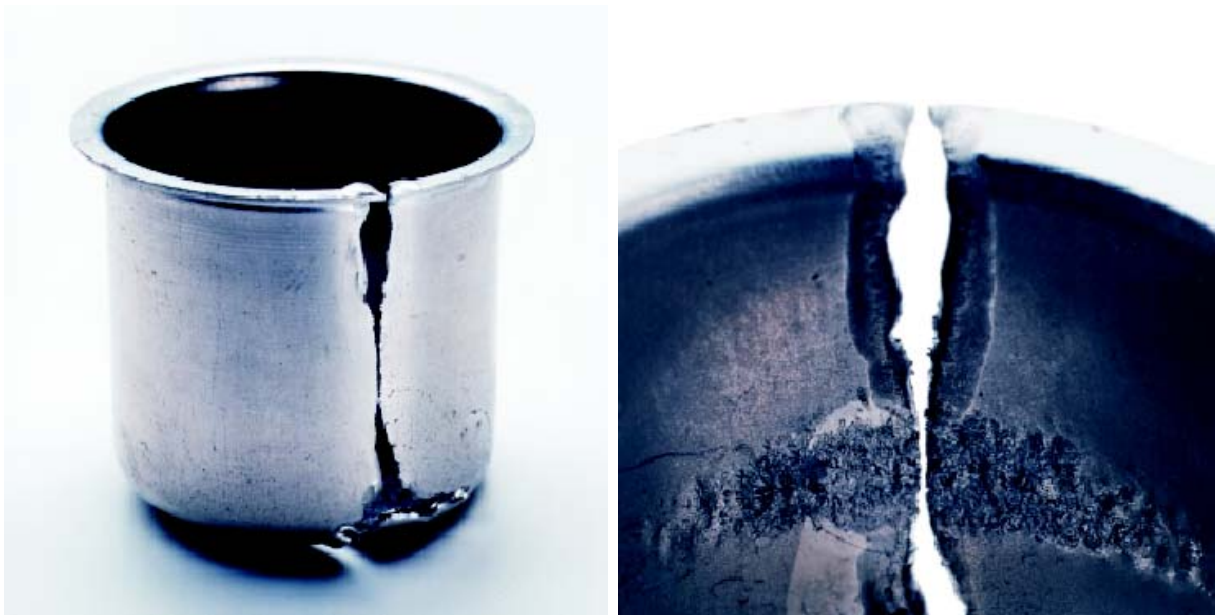
Bild 6 Lokale Aufschmelzung eines Pt-Tiegels.
