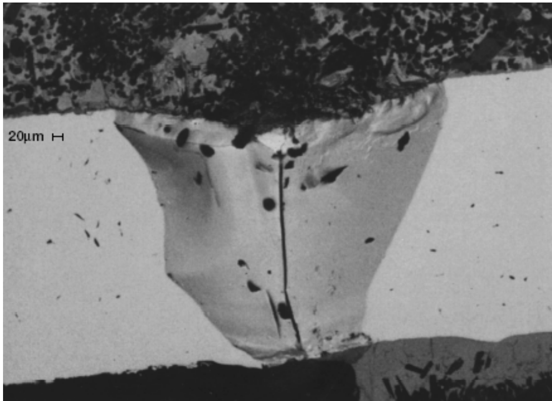
Bild 13 Querschliff durch eine Pt-Tiegelwand nach Einwirkung einer hoch wismuthaltigen Schmelze.
